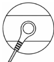
Рис. 1. Способ подключения провода к электроду
