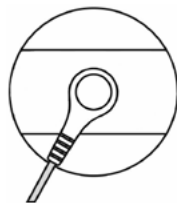
Obr. 1. Spôsob pripojenia kábla k elektróde
