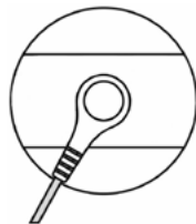
Fig. 1. Modalità di collegamento del cavo all'elettrodo
