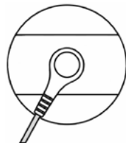
Obr. 1. Způsob připojení vodiče k elektrodě
